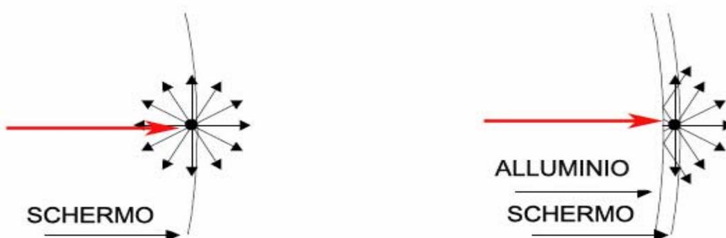
**Fig. 7 Schematizzazione della metallizzazione dello schermo**
