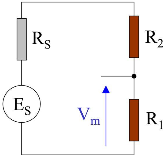
Si sostituisce al componente fisso un secondo sensore uguale al primo, ma le cui variazioni sono di segno contrario:
