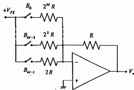
Fig.3.10.1 - Convertitore D/A con rete di resistori.
