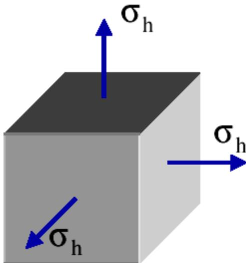
La tensione idrostatica causa una variazione di volume ma non di forma.
