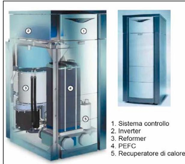
**Figura 10** Prototipo Vaillant/Plug Power in grado di erogare 4,5 kW<sub>e</sub>
