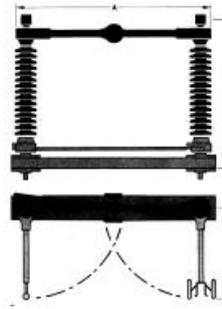
Fig. III.25 - Sezionatore a rotazione a due colonne.
