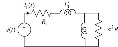
Trasformato il circuito in una rete di impedenze, nella quale si è introdotto il fasore  $\bar{E} = 10 \text{ V}$ , l'impedenza equivalente vista dal generatore è:
