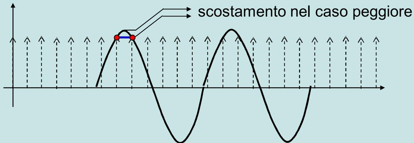
Per ottenere un errore di ricostruzione  $< 1\%$ , i campioni devono essere stati acquisiti con  $OSF \geq 5$  (cioè,  $F_S \geq 10 \cdot F_{MAX}$ )
