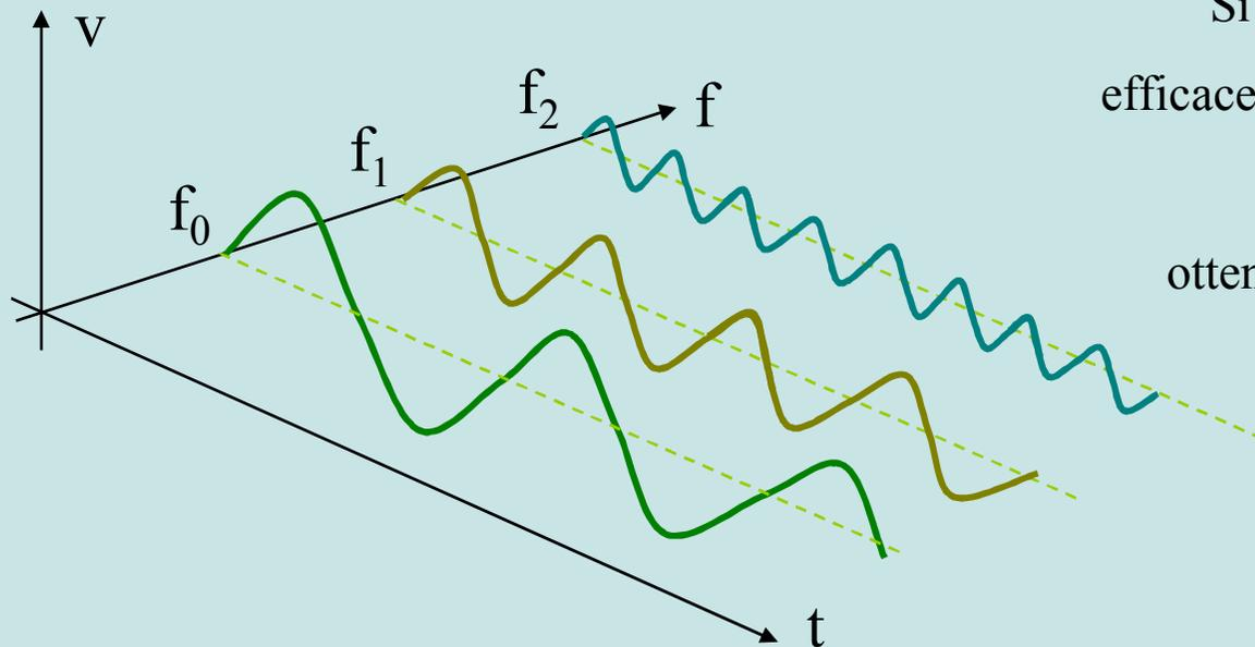
Si rappresenta il valore (massimo o efficace) di ampiezza di una componente armonica rispetto alla frequenza, ottenendo lo **spettro di ampiezza** del segnale.
