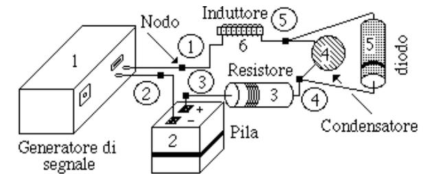
Fig. 1.10 Esempio di circuito costituito da componenti con due terminali.
