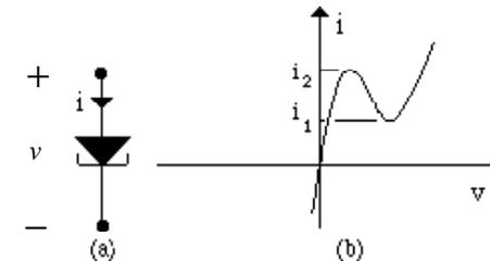
Fig. 1.31 (a) Simbolo del diodo tunnel e (b) curva caratteristica.
