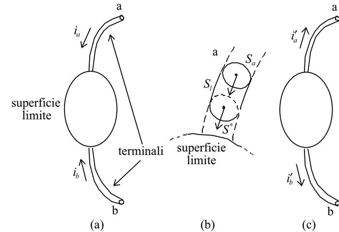
**Fig. 1.11** Schematizzazione di un generico componente con due terminali: (a), (c) possibili scelte per i versi di riferimenti per le intensità di corrente; (b) ingrandimento del terminale "a".
