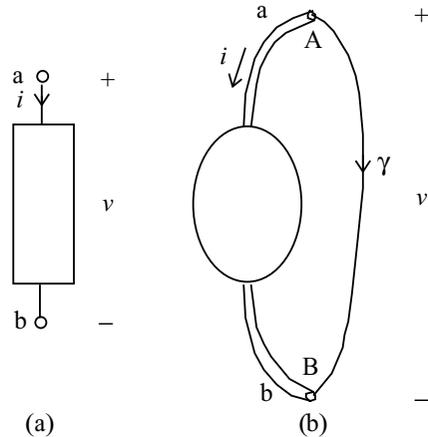
**Fig. 1.14** (a) Componente con due terminali; (b) simbolo del corrispondente bipolo.
