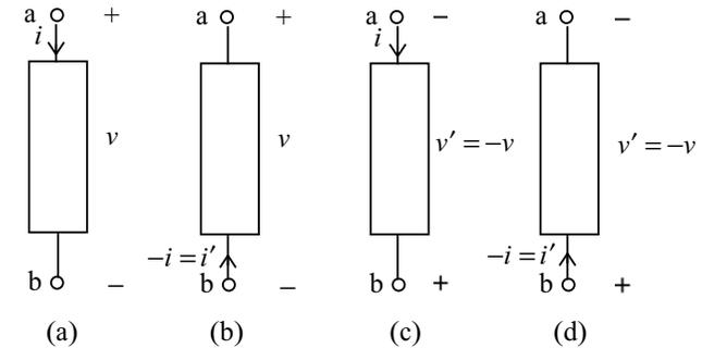
**Fig. 1.15** (a) e (d) Convenzione dell’utente (convenzione normale); (b) e (c) convenzione del generatore.
