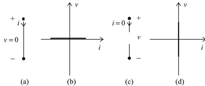
**Fig. 1.26** (a) simbolo del corto circuito e (b) relativa curva caratteristica; (c) simbolo del circuito aperto e (d) relativa curva caratteristica.
