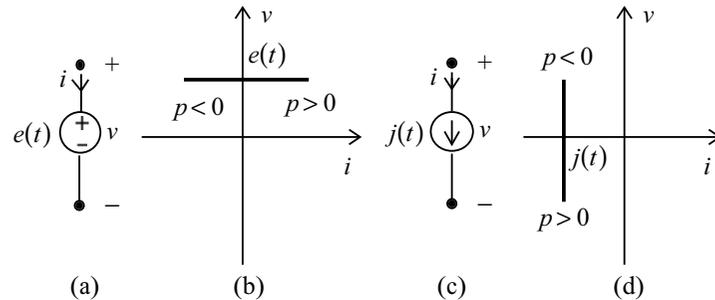
**Fig. 1.24** (a) simbolo del generatore indipendente di tensione e (b) relativa curva caratteristica; (c) simbolo del generatore ideale di corrente e (d) relativa curva caratteristica.
