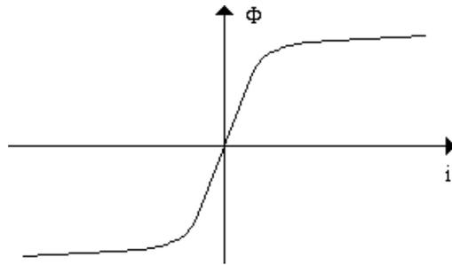
Fig. 1.36 Curva caratteristica dell'induttore saturabile
