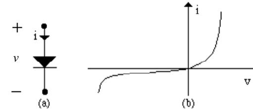
Fig. 1.30 (a) Simbolo del diodo e (b) curva caratteristica.
