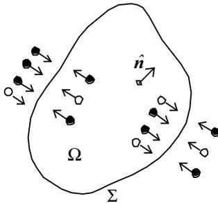
**Fig. 1.5** La carica totale contenuta nella regione  $\Omega$  varia nel tempo in presenza di una corrente elettrica attraverso la superficie chiusa  $\Sigma$ .
