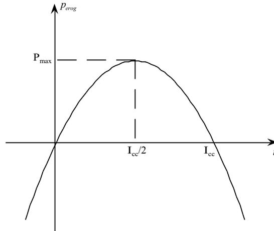
**Fig. 1.35** Andamento della potenza erogata da un generatore reale di tensione in funzione dell'intensità della corrente.
