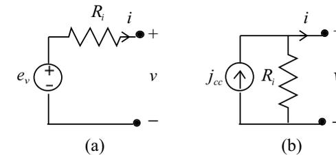
**Fig. 1.33** Modelli di un (a) generatore reale di tensione e (b) di un generatore reale di corrente.
