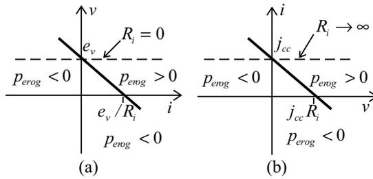
**Fig. 1.34** Curva caratteristica (concorde con la convenzione del generatore) (a) del generatore reale di tensione e (b) del generatore reale di corrente; le rette tratteggiate sono le curve caratteristiche dei rispettivi componenti considerati ideali.
