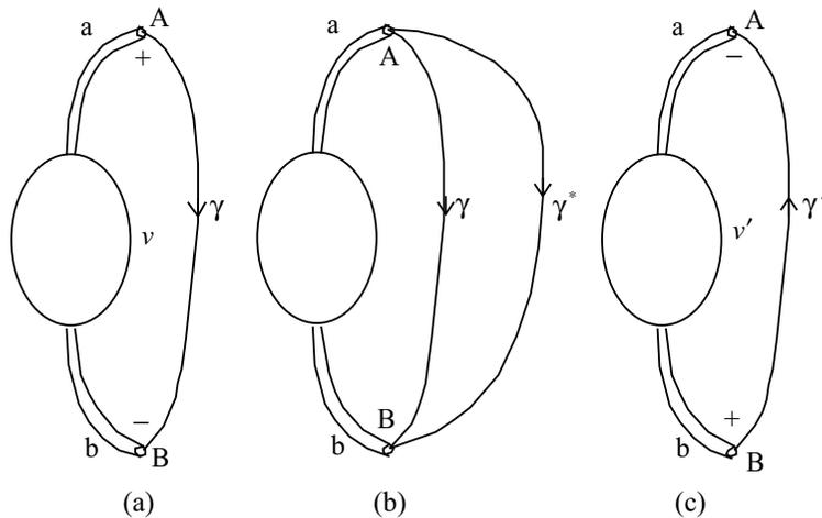
**Fig. 1.13** (a), (c) Componente con due terminali con versi di riferimento diversi per le tensioni; (b) due possibili cammini esterni alla superficie limite.
