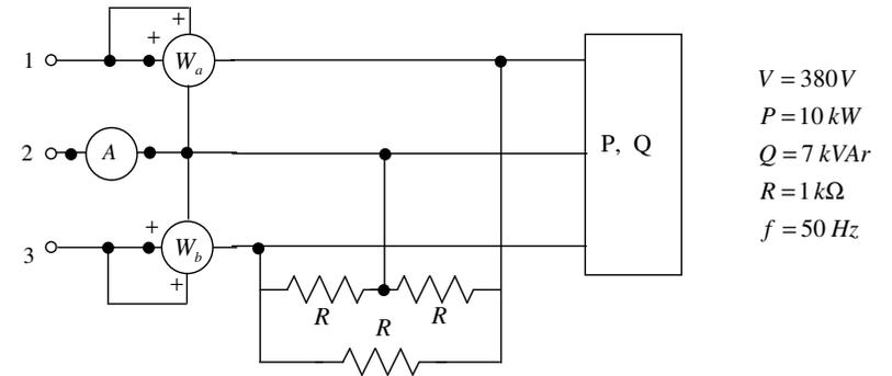
a) L'indicazione dell'amperometro fornisce il valore efficace I della corrente di linea alla sezione 1-2-3. Per calcolarla si può valutare la potenza complessa totale assorbita a tale sezione, sommando i contributi di tutti i carichi. I resistori assorbono la potenza complessa
