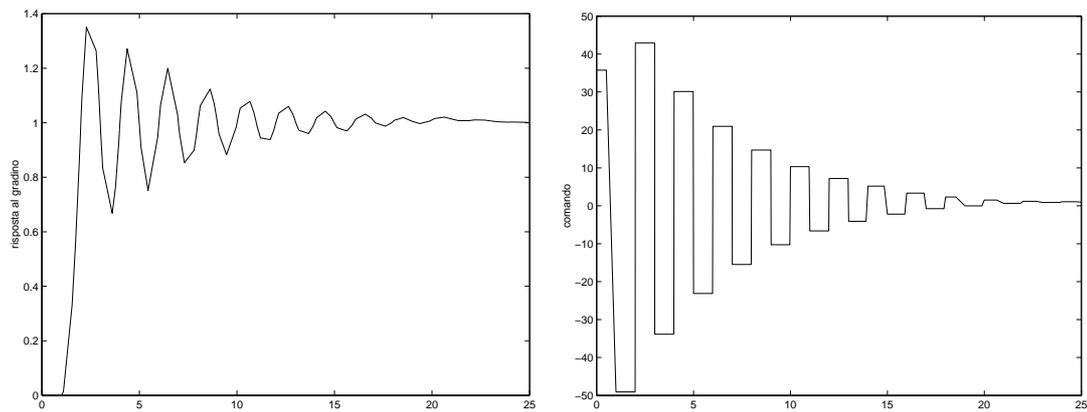
Figura 6.3: Esempio 6.4: Risposta al gradino (uscita e comando)
