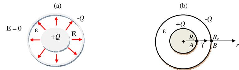
Fig. 7. Condensatore sferico
