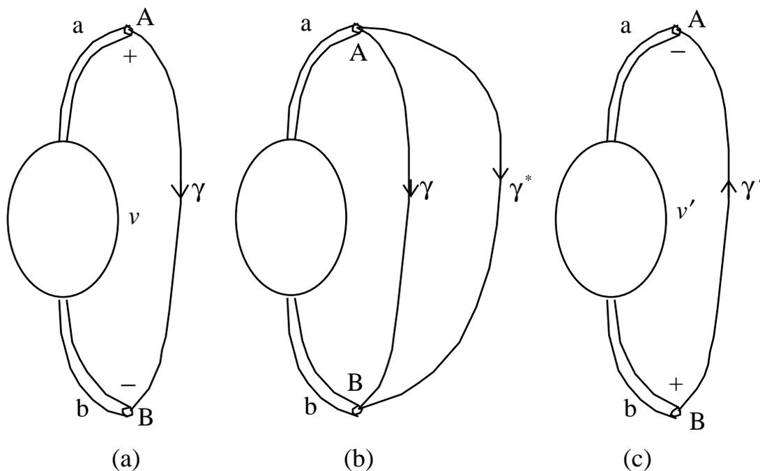
**Fig. 1.13** (a), (c) Componente con due terminali con versi di riferimento diversi per le tensioni; (b) due possibili cammini esterni alla superficie limite.
