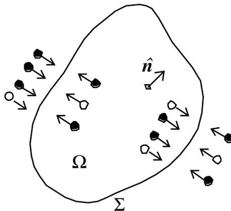
**Fig. 1.5** La carica totale contenuta nella regione  $\Omega$  varia nel tempo in presenza di una corrente elettrica attraverso la superficie chiusa  $\Sigma$ .
