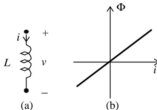
**Fig. 1.37** (a) Simbolo di un induttore lineare e (b) curva caratteristica  $i - \Phi$ .
