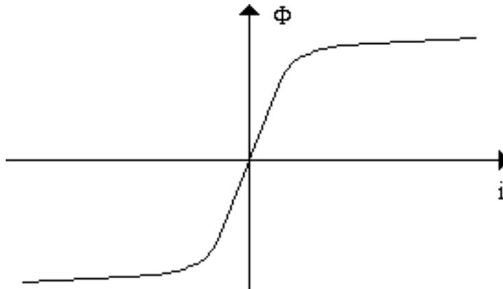
**Fig. 1.36** *Curva caratteristica dell'induttore saturabile*
