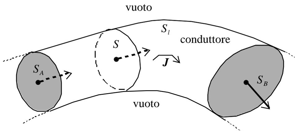
**Fig. 1.6** *In condizioni stazionarie l'intensità della corrente elettrica attraverso una generica sezione di un conduttore filiforme non dipende dalla particolare sezione scelta.*
