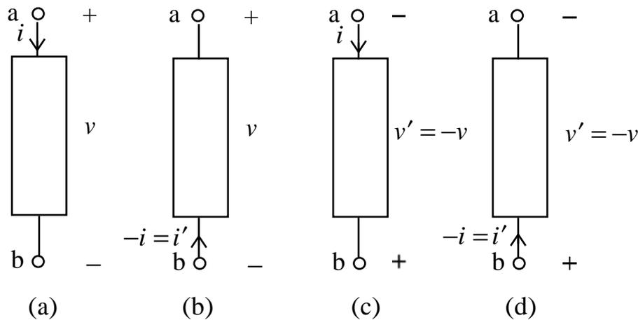
**Fig. 1.15** (a) e (d) Convenzione dell'utilizzatore (convenzione normale); (b) e (c) convenzione del generatore.
