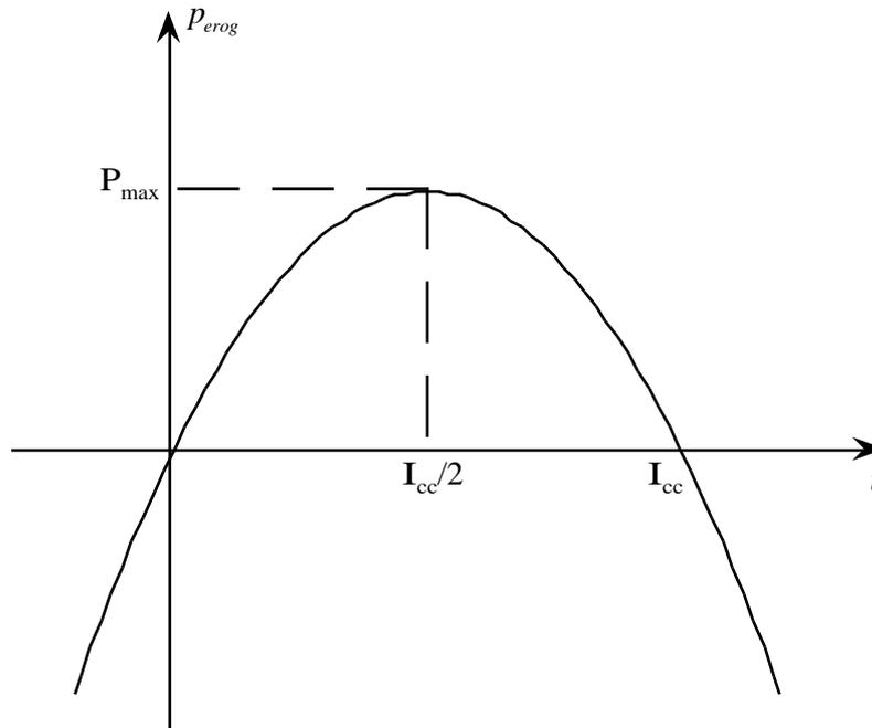
**Fig. 1.35** *Andamento della potenza erogata da un generatore reale di tensione in funzione dell'intensità della corrente.*
