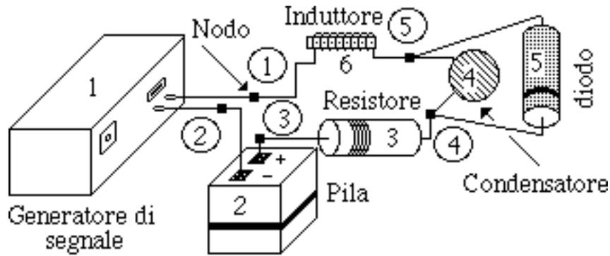
**Fig. 1.10** Esempio di circuito costituito da componenti con due terminali.
