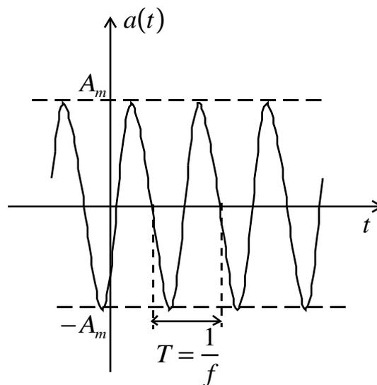
**Fig. 1.12** Andamento nel tempo di una funzione sinusoidale.
