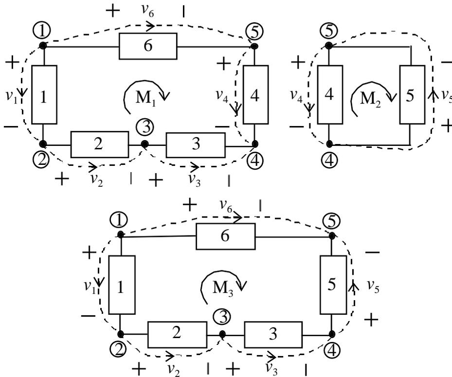
**Fig. 1.20** Le maglie del circuito di Figura 1.16.
