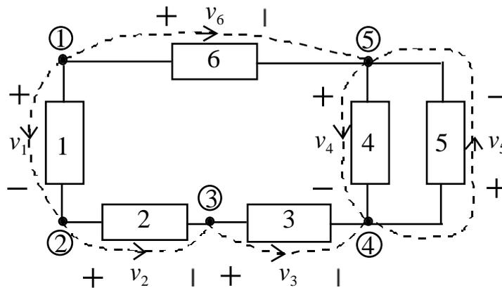
**Fig. 1.18** “Percorsi” del circuito elettrico rappresentato in Figura 1.10.
