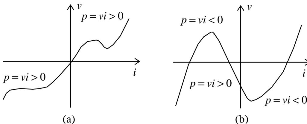
**Fig. 1.32** (a) Curva caratteristica di un generico bipolo adinamico passivo e (b) di un bipolo adinamico attivo.
