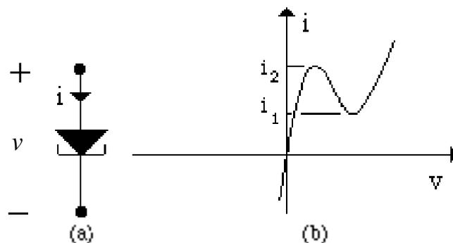
**Fig. 1.31** (a) Simbolo del diodo tunnel e (b) curva caratteristica.
