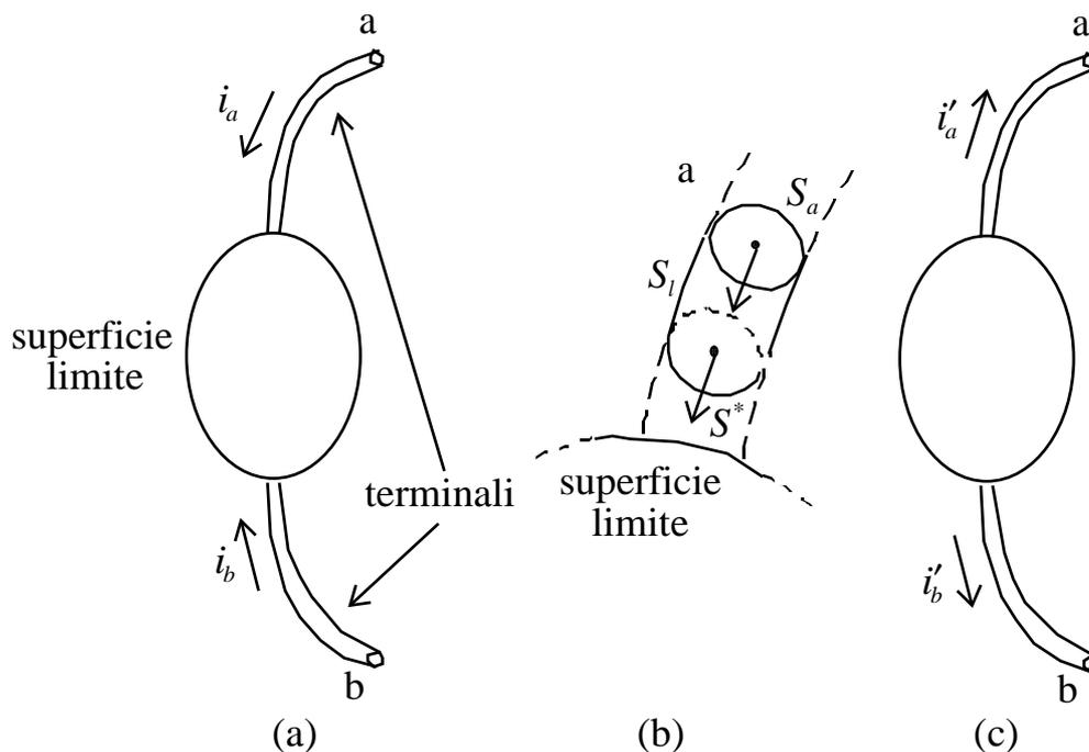
**Fig. 1.11** Schematizzazione di un generico componente con due terminali: (a), (c) possibili scelte per i versi di riferimenti per le intensità di corrente; (b) ingrandimento del terminale “a”.
