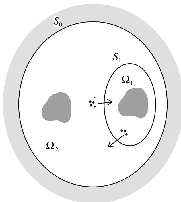
**Fig. 1.3** *Sistema elettromagnetico chiuso: attraverso la superficie  $S_0$  non c'è passaggio di cariche elettriche.*
