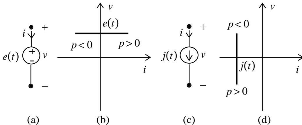
**Fig. 1.24** (a) simbolo del generatore indipendente di tensione e (b) relativa curva caratteristica; (c) simbolo del generatore ideale di corrente e (d) relativa curva caratteristica.
