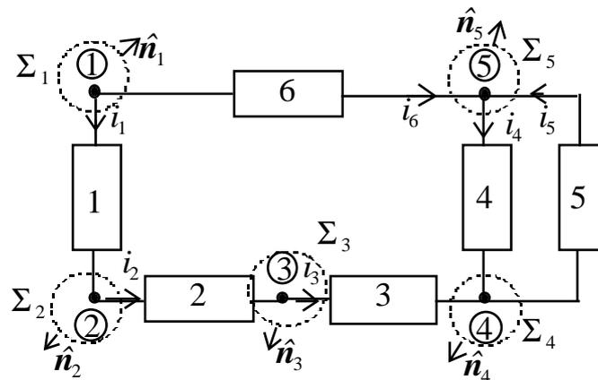
**Fig. 1.17** A ciascun nodo del circuito di Figura 1.10 (Figura 1.16) corrisponde una superficie chiusa.
