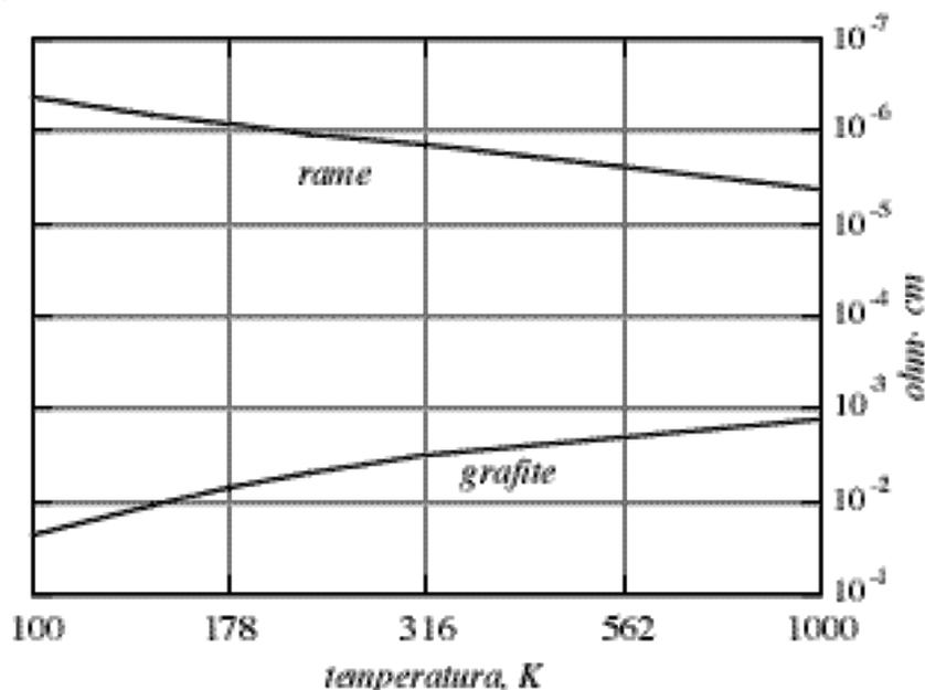
**Fig. 1.23** Resistività del rame e della grafite in funzione della temperatura.
