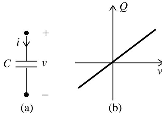
**Fig. 1.36** (a) Simbolo di un condensatore lineare e (b) curva caratteristica  $v - Q$ .
