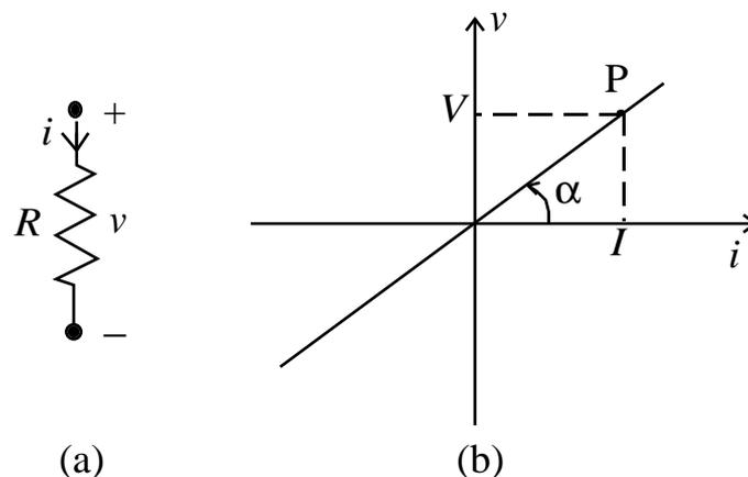
**Fig. 1.22** (a) simbolo del resistore lineare e (b) relativa curva caratteristica per  $R > 0$ .
