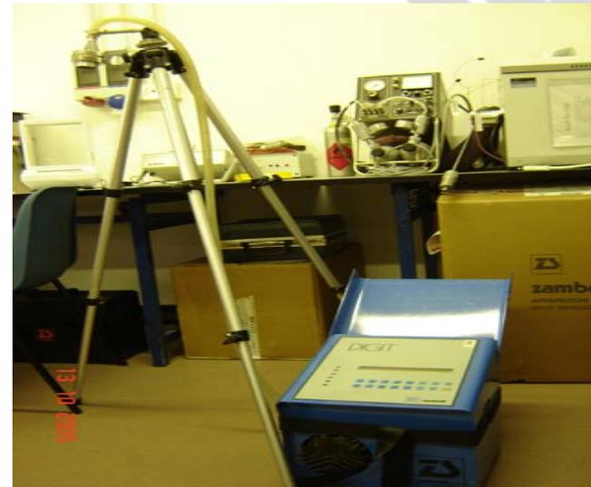
Il materiale particolato totale sospeso (PTS) viene determinato attraverso la filtrazione dell'aria con conseguente raccolta del particolato in sospensione in aria. La concentrazione finale del materiale particolato viene ottenuta o attraverso pesatura del filtro e rapporto al volume di gas aspirato (metodo gravimetrico).
