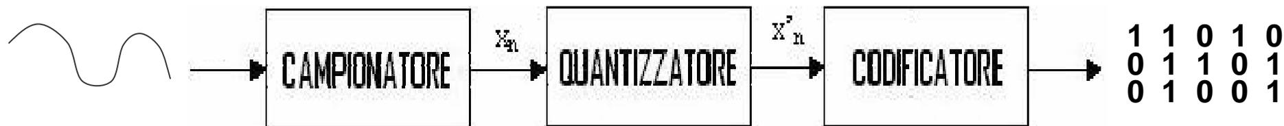
La conversione analogico-digitale trasforma un segnale analogico (valori continui in un tempo continuo) in segnale numerico (valori discreti in tempo discreto). Questa operazione è costituita da tre fasi:
