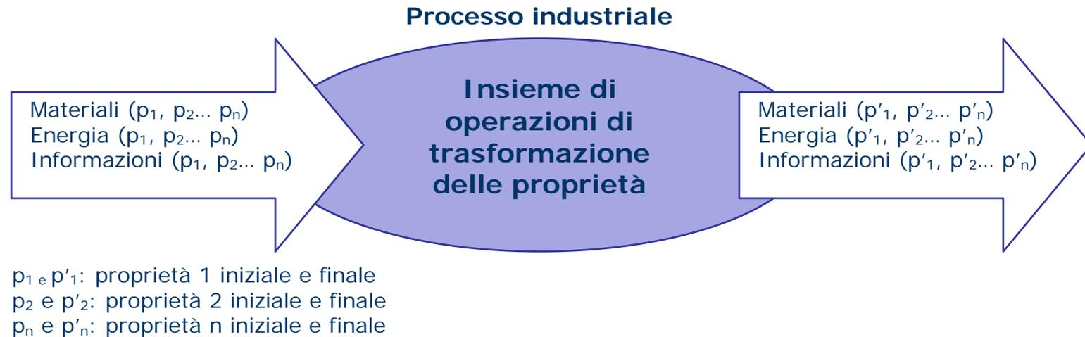
Il *processo industriale* può essere definito come l'insieme delle operazioni che concorrono a trasformare le proprietà di uno o più materiali, tipi di energia o informazioni con un obiettivo predeterminato; esempi tipici possono essere la produzione di un determinato bene attraverso una lavorazione continua oppure discreta di tipo manifatturiero, la produzione di energia elettrica oppure il suo trasporto e distribuzione, la raccolta-elaborazione – diffusione di informazioni.
