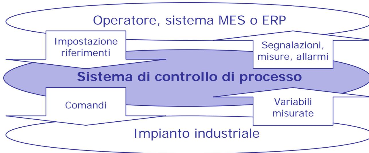
Il sistema che regola i comandi necessari al funzionamento dell'impianto e quindi al perseguimento dell'obiettivo del processo industriale, ne ottimizza le fasi e ne verifica i risultati è detto sistema di controllo di processo (**PCS, Process Control System**); oltre al processo stesso su cui agisce direttamente il controllo, questo è anche interfacciato al sistema superiore che ne imposta i comportamenti in funzione degli obiettivi che il processo deve conseguire.
